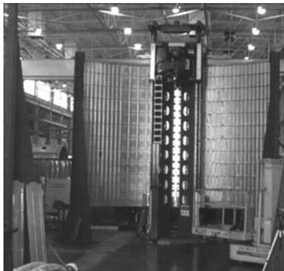
Рис. 12. Оборудование для СТП в вертикальном положении
