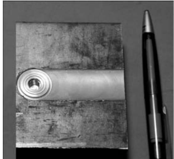
Рис. 3. Лицевая поверхность соединения латуни Л60, полученного СТП
