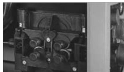
В источник питания интегрирован четырехроликковый привод для точной и беспрепятственной подачи проволоки
