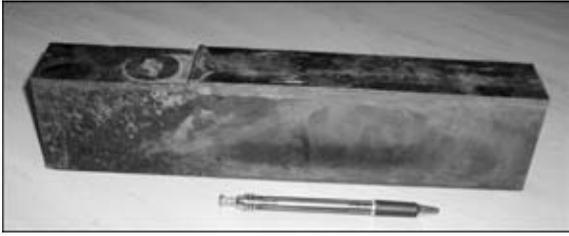
Рис. 10. Вид наплавленного фрагмента плиты медного кристаллизатора машины непрерывной разливки стали
