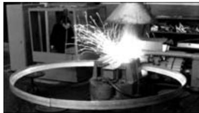
Контактная стыковая сварка шпангоутов на машине К393
