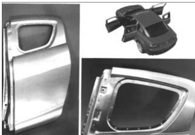
Рис. 11. Соединения, выполненные на автомобиле Mazda RX-8 с помощью точечной СТП [2]
