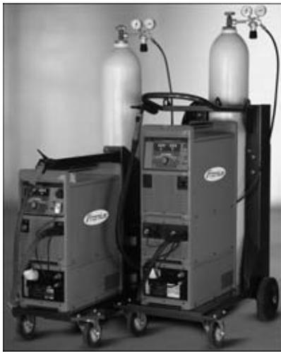
Алюминий всегда нуждается в специальном обращении, он его и заслуживает. Так, при сварке алюминия переменным током процессом TIG, как правило, используется не заостренный электрод, а электрод со сферической контактной поверхностью. В случае сварки угловых швов это приводит к недостаточному провару корня шва. Аппараты MagicWave при заостренном электроде обеспечивают сферическую контактную поверхность значительно меньшего диаметра, что обеспечивает оптимальный провар корня.
