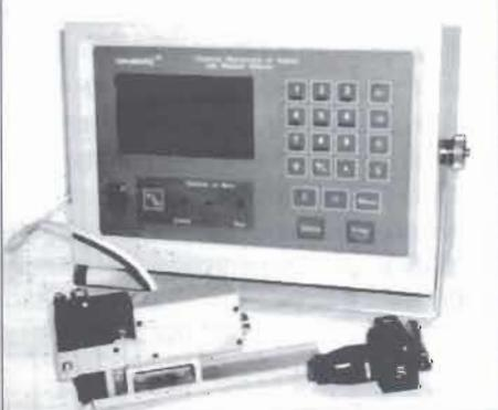
**Назначение.** Оперативное определение в элементах металлоконструкций значения и знака одно-, двух- и трехосных остаточных напряжений без разрушений; контроль поля остаточных напряжений при послесварочной упрочняющей обработке в процессе изготовления и эксплуатации конструкции.
