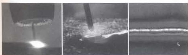
Рис. 1. Динамические сюжеты «Навигатора» по формированию сварочной ванны и сварного шва
