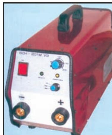
кочастотных преобразователей (инверторов). Среди них: выпрямитель типа ВДЧ-201 УЗ.1 класса «PROFFI», предназначенный для ручной дуговой сварки покрытыми электродами на постоянном токе с плавным регулированием (5...200 А) различных низко- и высоколегированных сталей и сплавов;
