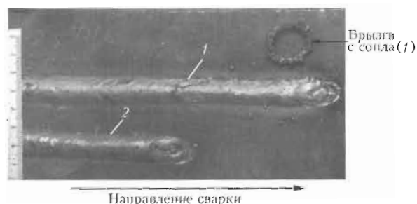
Рис. 1. Внешний вид металла швов при ИДСПЭ стали СтЗсп проволокой Св-08Г2С диаметром 1,6 мм в смеси газов 82\% \text{ Ar} + 18\% \text{ CO}_2 (скорость сварки 16 м/ч, длительность импульса 3,4 мс): 1 — U_c = 376...380 \text{ В} (первая половина шва), 342...354 В (вторая); K_p = 6,5...7\% ; 2 — U_c = 376...380 \text{ В} ; I_{cp} = 250 \text{ А} ; U_{cp} = 25 \text{ В} ; частота импульсов 82 Гц; K_p = 1...1,5\%
