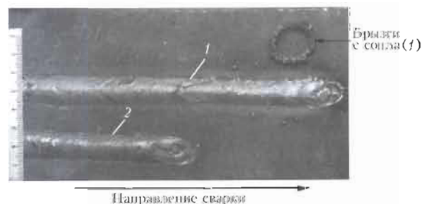
Рис. 1. Внешний вид металла швов при ИДСПЭ стали СтЗсп проволокой Св-08Г2С диаметром 1,6 мм в смеси газов 82\% \text{ Ar} + 18\% \text{ CO}_2 (скорость сварки 16 м/ч, длительность импульса 3,4 мс): 1 — U_c = 376...380 \text{ В} (первая половина шва), 342...354 В (вторая); K_p = 6,5...7\% ; 2 — U_c = 376...380 \text{ В} ; I_{cp} = 250 \text{ А} ; U_{cp} = 25 \text{ В} ; частота импульсов 82 Гц; K_p = 1...1,5\%
