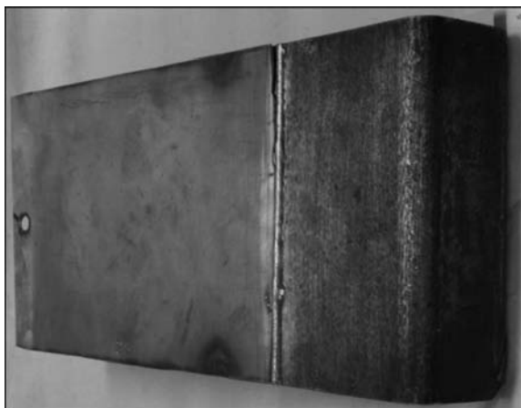
Рис. 3. Испытуемый образец-имитатор соединения обшивки боковой стенки с каркасом главной рамы дизель-поезда
