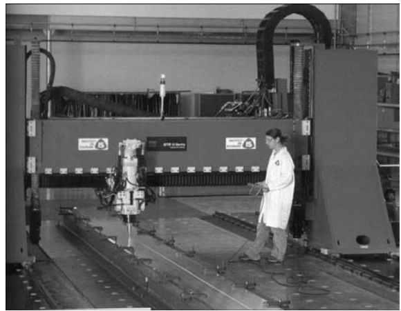
Рис. 3. Машина для сварки трением с перемешиванием (длина шва 14 м) в центре г. Метц
