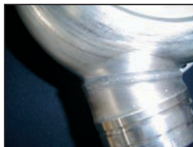
Фланец трубы из нержавеющей стали 1.4301, сваренный с помощью процесса Puls-Mix ( v_{св} = 60 см/мин)
