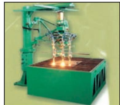
Машина может успешно использоваться для вырезки готовых деталей типа фланцев, косынок, планок и т. д.
