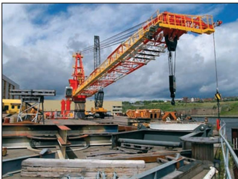
Ведущая роль швов: стрелы кранов, которые выдерживают экстремально высокие нагрузки на судовой поверхности, и морские буровые установки изготавливаются посредством соединения труб и профилей
