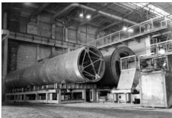
Рис. 2. Стан для производства крупных сварных рулонизируемых полотнищ, построенный на Новокузнецком заводе резервуарных металлоконструкций в 1974 г.
