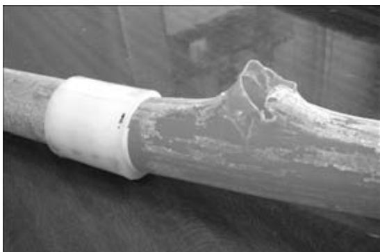
Рис. 4. Образец соединения труб с наружным диаметром 50 мм и толщиной стенки 4,6 мм из структурированного полиэтилена марки РЕ-Ха после проведения гидравлических испытаний
