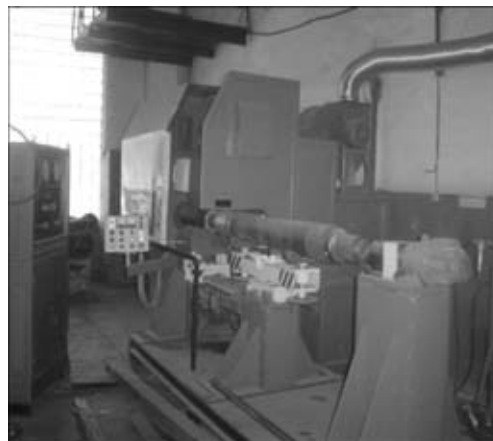
Рис. 3. Общий вид установки КТ-088 для восстановления шейки и подступичной части оси колесной пары способом плазменно-дуговой металлизации
