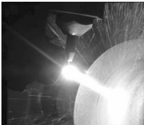
Рис. 4. Процесс плазменно-дуговой металлизации шейки оси
