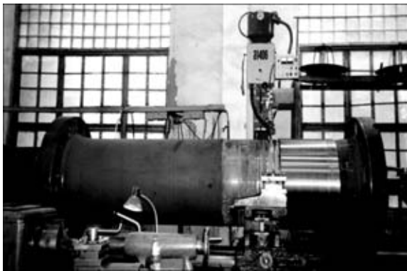
Рис. 2. Модернизированная установка, созданная на базе токарного станка РТ-166, для наплавки и последующей механической обработки валов гидротурбин
