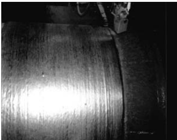
Рис. 3. Внешний вид наплавленного на вале гидротурбины коррозионностойкого слоя
