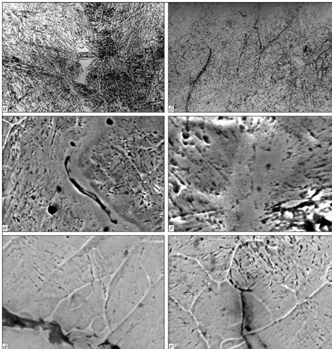
Рис. 4. Микроструктура мартенситных швов с  $\delta$ -ферритом (*a, б*) и вид трещин в швах, образовавшихся при релаксационных испытаниях (*в-е*): *a, б* —  $\times 500$ ; *в, д* —  $\times 2020$ ; *з* —  $\times 4780$ ; *е* —  $\times 1690$
