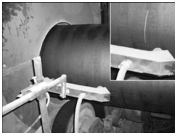
Рис. 3. Телевизионный сенсор, сканирующий поверхность вращающейся трубы
