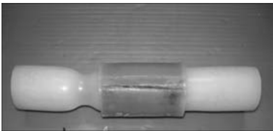
Рис. 2. Образец, выдержавший испытание на растяжение, без разрушения соединения (на трубе рядом с муфтой «шейка» — след остаточных деформаций)
