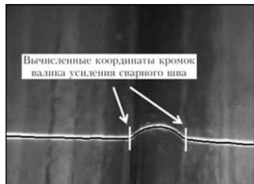
Рис. 4. Результат определения координат кромок валика усиления сварного шва с помощью нейросетевого алгоритма
