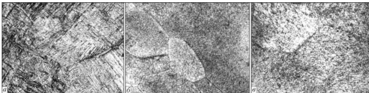
Рис. 5. Микроструктура металла швов сварных соединений титановых сплавов, выполненных лазерной сваркой: а — ВТ6 (Х200); б — ВТ23 (Х400); в — Т110 (Х400)
