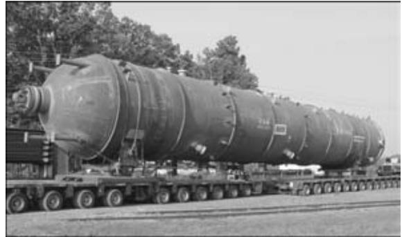
Рис. 4. Реактор для гидрогенизации (диаметр 4500 мм, масса более 1000 т), плакированный нержавеющей сталью
