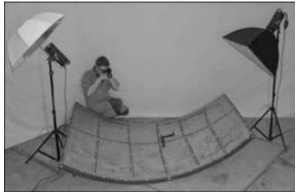
Рис. 9. Определение формы отштампованной взрывом панели из нержавеющей стали толщиной 60 мм фотограмметрическим методом с использованием штрих-кодов
