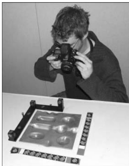
Рис. 4. Изготовление цифровых снимков для фотограмметрического анализа
