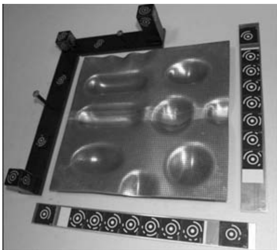
Рис. 5. Пробный образец с набором форм, представляющих различные пути деформации
