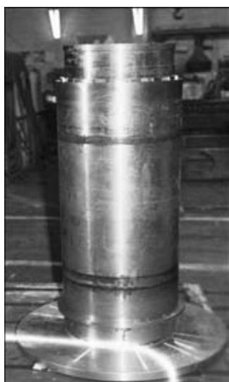
Рис. 4. Внешний вид биметаллического цилиндрического кристаллизатора
