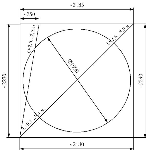
Рис. 2. Схема разметки биметаллической заготовки из стали 09Г2С + титан Вt1-0 под вырезку трубной доски и образцов для исследования
