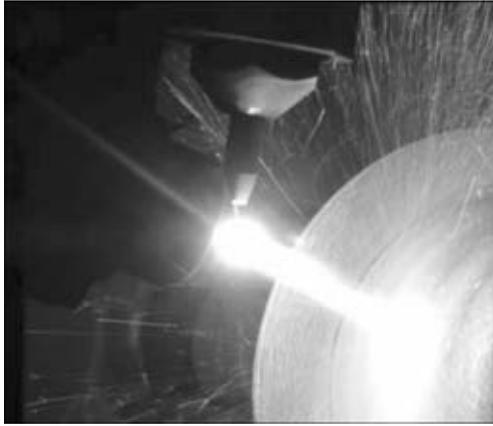
Рис. 4. Процесс плазменно-дуговой металлизации шейки оси
