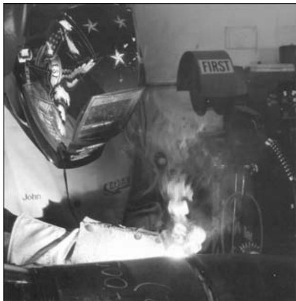
проплавления по всей толщине свариваемого металла. Система ProPulse™ обеспечивает поддержание оптимального значения сварочного тока и напряжения в зависимости от типа и диаметра присадочной проволоки, скорости подачи проволоки и состава газовой защиты.
