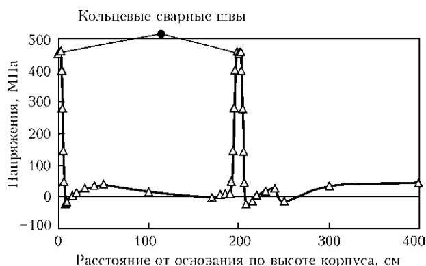
Рис. 4. Суммарные напряжения в оболочке корпуса хранилища
