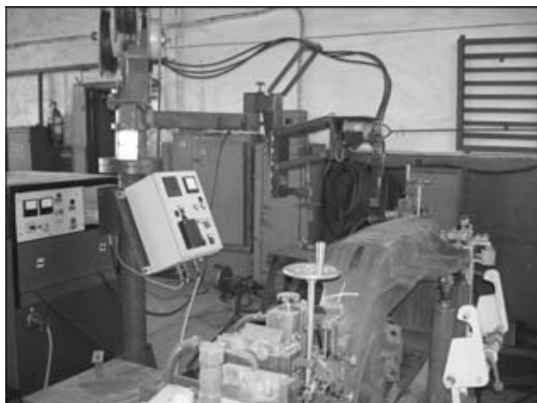
Рис. 4. Опытно-промышленная установка для наплавки направляющих поверхностей буксового проема боковой рамы тележки грузового вагона модели 18-100
