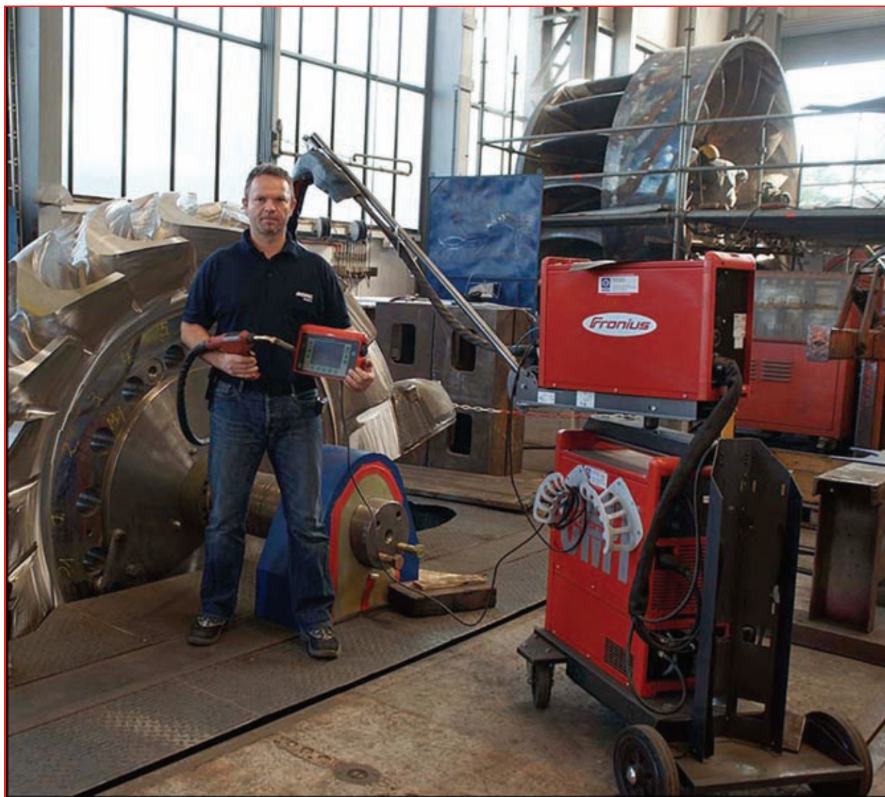
Сварщик Вольфганг Хартль убежден в эффективности систем для плакирования ходовых колес и судовых силовых установок. Он и его коллеги используют источник сварочного тока TransPuls Synergic 5000 CMT
