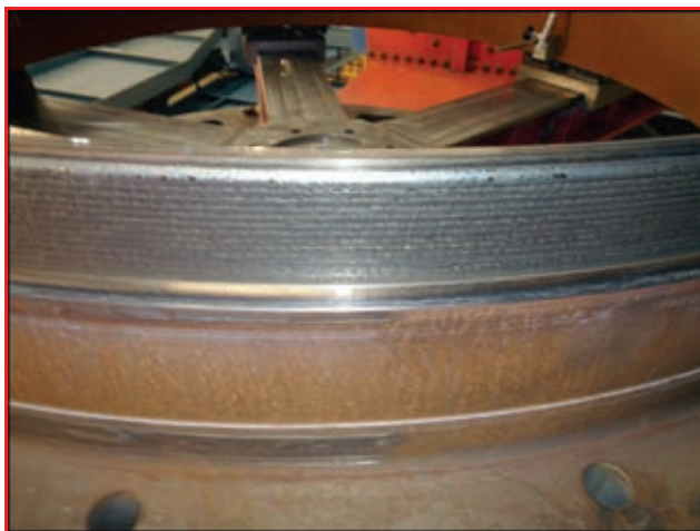
Использование метода CMT позволяет специалистам компании «Andritz Hydro» выполнять плакирование значительно быстрее, эффективнее, а также повышает автоматизацию процесса — например, при работе с уплотнительными фланцами для плакирования и создания сварных соединений
