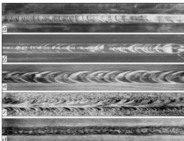
Рис. 3. Внешний вид сварных соединений сплавов АМг6 (а), 1201 (б), АМг3 (в), АД0 (г) и ИМВ-2 (д), полученных электронно-лучевой сваркой в условиях кратковременной невесомости на ЛЛ Ту-104А
