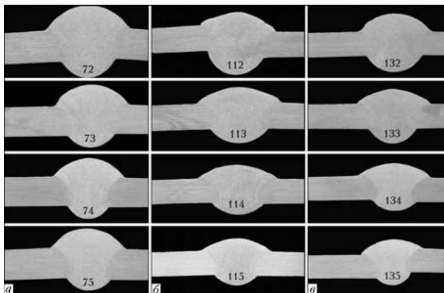
Рис. 4. Макроструктура (×4) швов в зависимости от режимов сварки сплава 1915Т проволокой диаметром 1,2 мм с модуляцией  $U_d$  (а), с одновременной модуляцией  $v_{п.пр}$ ,  $v_{св}$  (б) и с одновременной модуляцией  $U_d$ ,  $v_{п.пр}$  и  $v_{св}$  (в)
