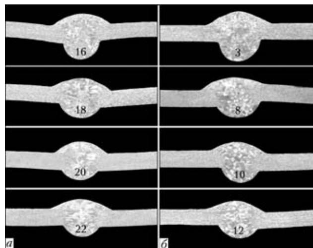
Рис. 1. Макроструктуры (×3) швов в зависимости от режимов сварки сплава АМгб проволокой диаметром 1,2 мм с модуляцией  $v_{п.пр}$  (а) и  $v_{св}$  (б). Здесь и далее цифры на шлифах отвечают номерам образца
