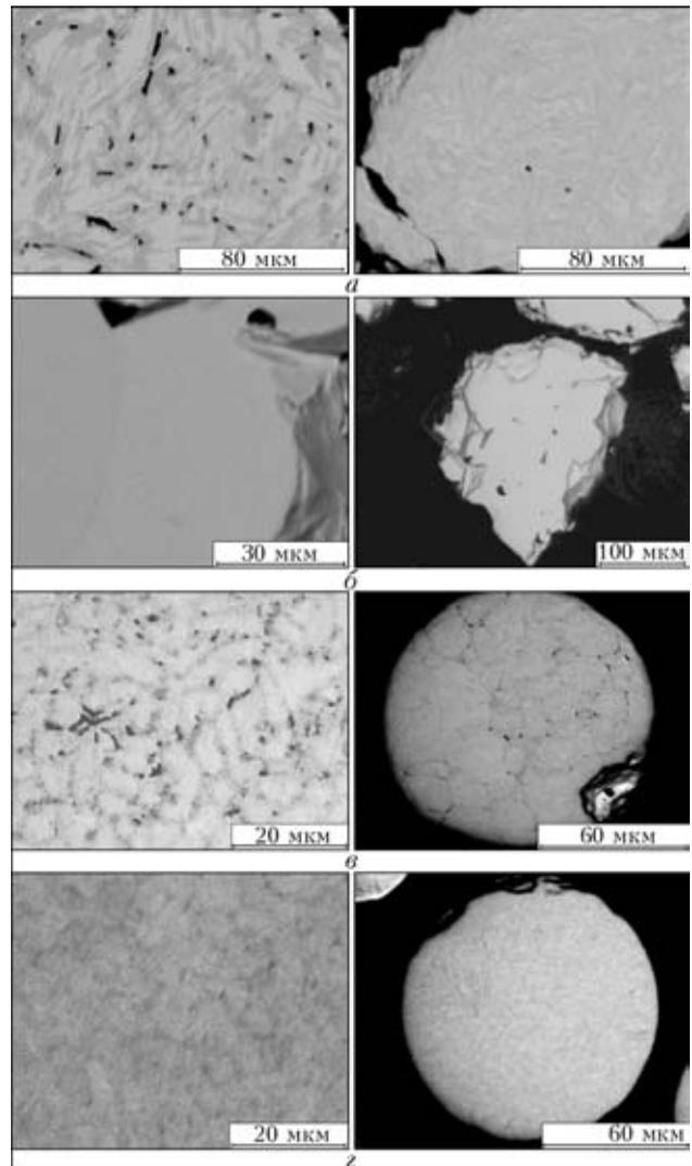
Рис. 3. Электронно-микроскопический вид частиц карбида вольфрама, полученных по различным технологиям: *a* — дробленый; *б* — макрокристаллический; *в* — сферический (оплавленный); *г* — сферический (распыленный)
