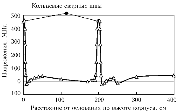
Рис. 4. Суммарные напряжения в оболочке корпуса хранилища
