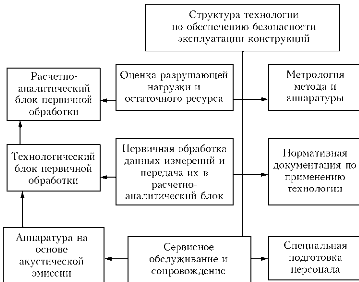
Рис. 3. Схема технологии контроля системой ЕМА 3
