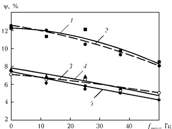
Рис. 2. Изменение коэффициента потерь электродного металла на разбрызгивание при сварке с импульсными ЭМВ: 1, 4, 5 — сварка соответственно в  $\text{CO}_2$ , в смеси 82 % Ar + 18 %  $\text{CO}_2$  и в Ar; 2, 3 — сварка порошковой проволокой ППТ-9 соответственно при  $U_d = 26$  и 34 В
