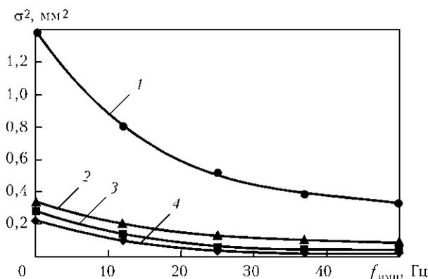
Рис. 1. Зависимость дисперсии распределения размеров капель электродного металла от частоты аксиальных импульсных УМП при сварке порошковой проволокой ППТ-9 (1), сваркой в  $\text{CO}_2$  (2), в смеси 82 % Ar + 18 %  $\text{CO}_2$  (3) и в Ar (4)
