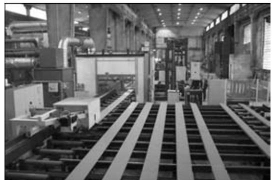
Рис. 1. Общий вид линии резки профилей с ЧПУ
