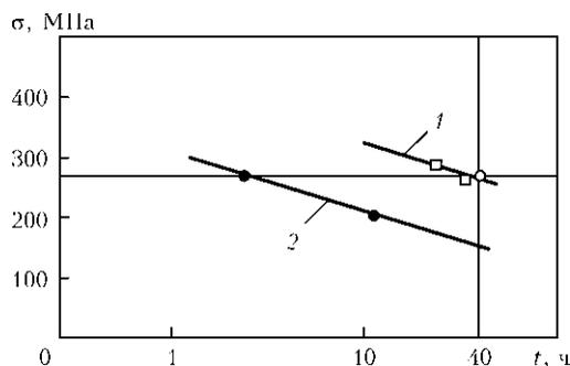
Рис. 8. Длительная прочность  $\sigma$  при  $T = 1000$  °С основного металла (1) и образца (2), имитирующего однослойную наплавку бандажной полки: □, ○ — соответственно экспериментальные и литературные данные
