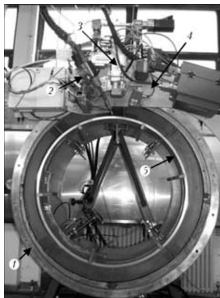
Рис. 1. Устройство для орбитальной лазерно-дуговой сварки
