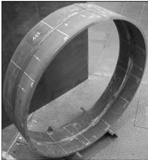
Рис. 6. Образец, выполненный полуорбитальной гибридной сваркой
