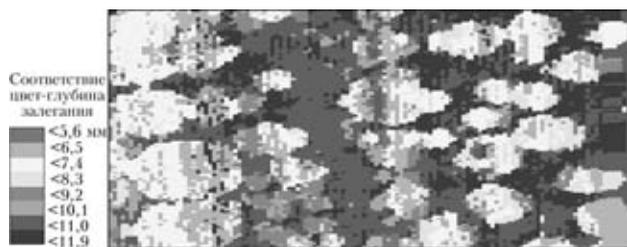
Рис. 5. Фрагмент участка сканирования с водородным растрескиванием элемента корпуса абсорбера, изготовленного из стали СтЗсп5 толщиной 12 мм (размер участка 250×250 мм)
