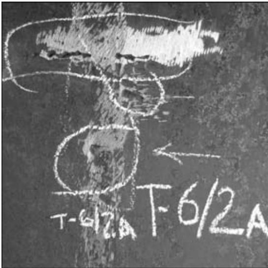
Рис. 8. Высокотемпературное растрескивание сварного шва теплообменника, изготовленного из стали 12ХМ, в зоне ремонтной подварки
