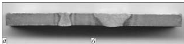
Рис. 1. Макрошлифы поперечных сечений швов с полным проплавлением, выполненных на сплаве Nimonic-75 сваркой А-ТИГ на I_{св} = 100 А (а) и сваркой ТИГ на I_{св} = 180 А (б) при одинаковой (200 мм/мин) скорости сварки
