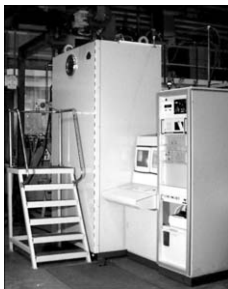
Рис. 8. Внешний вид специализированной установки УЛ-178М для электронно-лучевой сварки труб с трубными досками
