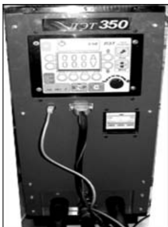
Рис. 2. Вариант конструктивного исполнения источника сварочного тока ЛЭТ 350 с металлической обшивкой и дисплеем сенсорного типа
