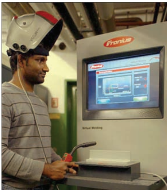
Система виртуальной сварки переносит в виртуальную реальность даже незначительные движения руки со сварочной горелкой, которые затем воспроизводятся на экране тренажера и через специальные очки маски сварщика
