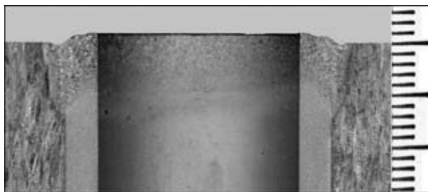
Рис. 9. Макрошлиф ( \times 3 ) сварного соединения выступающей трубки ( D_{\text{т}} = 27 мм с толщиной стенки \delta = 3 мм) с трубной доской, полученного электронным пучком с одинарным преломлением и перемещением трубки по координатам x и y по диаметру ее окружности, на следующем режиме сварки: U_{\text{уск}} = 60 кВ; I_{\text{п}} = 30 мА; v_{\text{св}} = 15 мм/с; f_{\text{л}} = 200 мм
