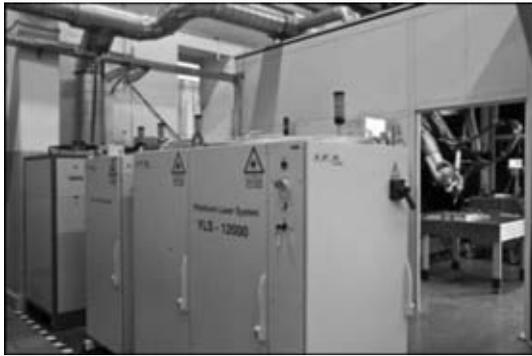
Рис. 13. Оптоволоконная лазерная система YLS-12000
