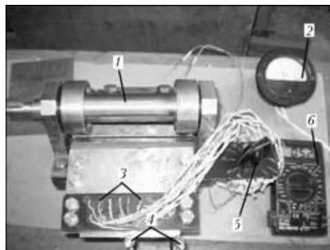
Рис. 4. Внешний вид приспособления для преобразования поперечных колебаний в продольные и расположение датчиков распределения тока по ширине ленточного электрода: 1 — эксцентриковый механизм; 2 — амперметр; 3 — датчики съема тока; 4 — контакты, имитирующие дугу; 5 — переключатель; 6 — милливольтметр
