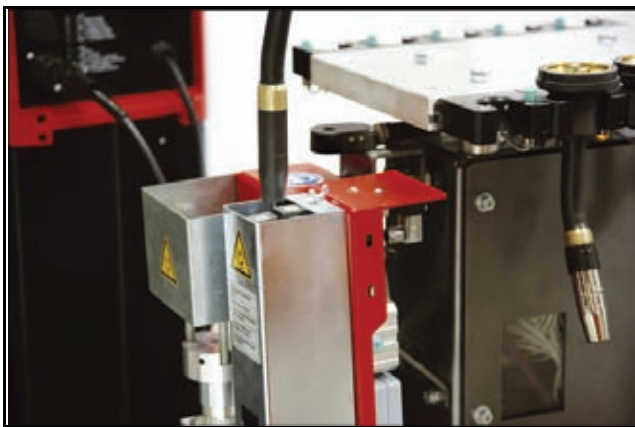
После установки нового корпуса горелки сварочная проволока пропускается сквозь корпус горелки и отрезается до нужного вылета электрода
