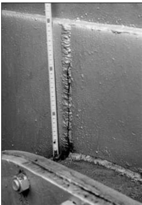
Рис. 2. Развитие трещины в кольцевом шве, выполненном на усиливающей накладке овального люка, в резервуаре для хранения нефти из стали 09Г2С-12 вместимостью 20 тыс. м 3 с толщиной стенки 16 мм
