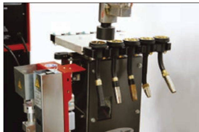
Робот меняет корпус горелки для выполнения различных сварочных заданий или корпус горелки с новой контактной трубкой автономно, а также в зависимости от ситуации и потребности
