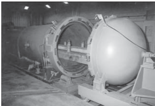
Рис. 1. Взрывная камера КВГ-16 с выдвинутым рабочим столом
