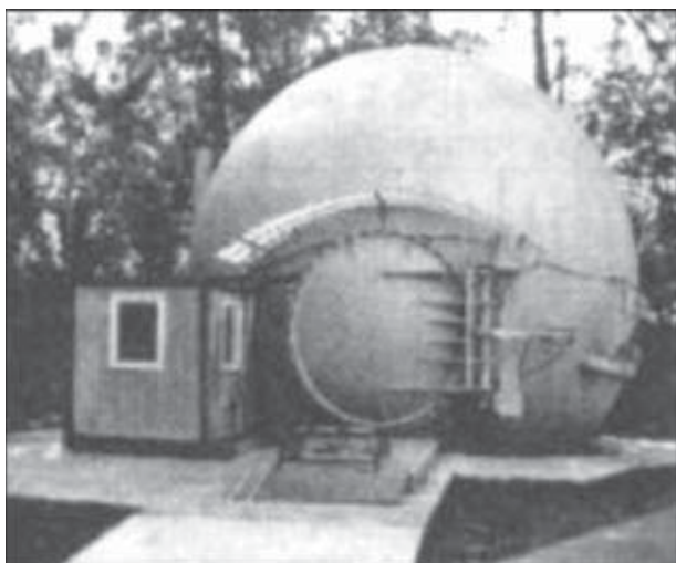
Рис. 2. Полуавтоматическая взрывная камера ВК-10
