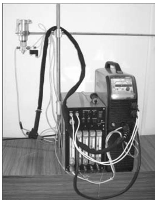
Рис. 2. Установка PPS002 для микроплазменной наплавки
