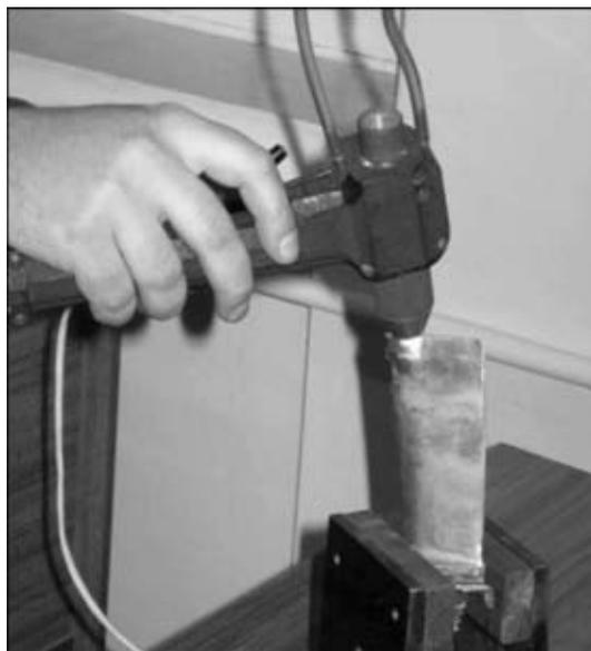
Рис. 3. Наплавка на торец пера лопатки турбины
