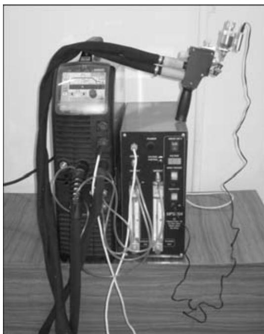
Рис. 1. Установка MPS004 для микроплазменного напыления
