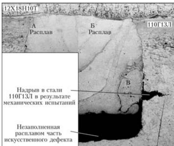
Рис. 3. Микроструктура (×25) соединения в зоне искусственного дефекта
