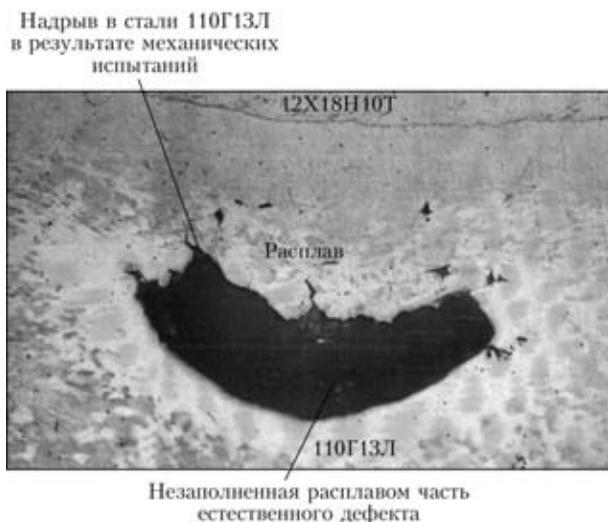
Рис. 6. Микроструктура (×25) соединения в зоне естественного дефекта
