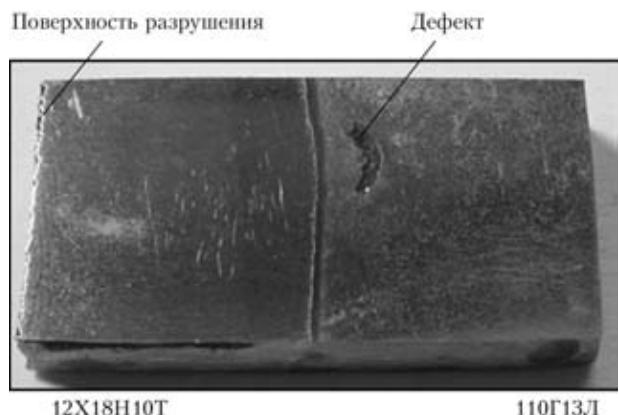
Рис. 4. Макрошлиф соединения с естественным дефектом
