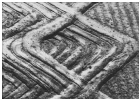
Рис. 1. Поверхность валика с наплавленными валиками зигзагообразной формы
