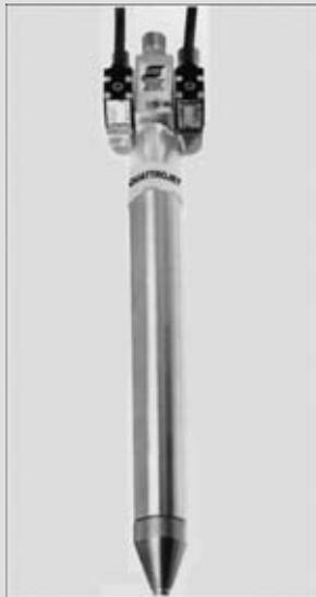
Снабженная автоматическим контролем пламени новая кислородно-топливная горелка распознает любое потенциальное нарушение процесса резки и автоматически останавливает подачу газа. Таким образом, в отличие от традиционных систем машина для резки не требует постоянного контроля оператора, так как любая утечка топливного газа и кислорода эффективно предотвращается. Устройство контроля пламени реагирует на любые дефекты в обрабатываемом материале и на любые неисправности режущего инструмента.
