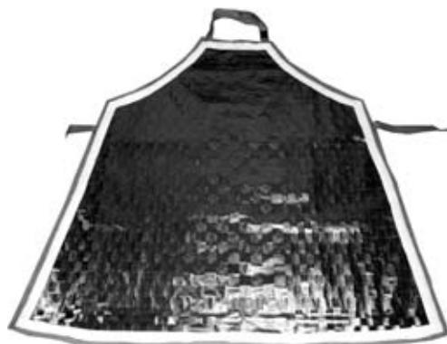
Рис. 3. Опытный образец защитного фартука сварщика без подкладки (вид с обратной стороны)
