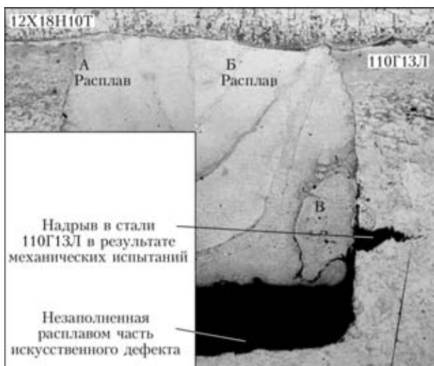
Рис. 3. Микроструктура (×25) соединения в зоне искусственного дефекта
