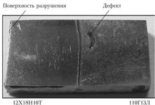
Рис. 4. Макрошлиф соединения с естественным дефектом
