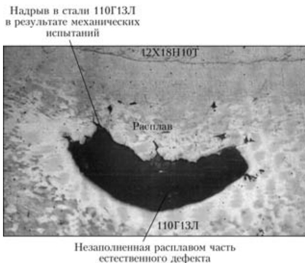
Рис. 6. Микроструктура (×25) соединения в зоне естественного дефекта
