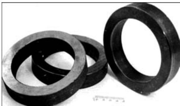
Рис. 1. Вид колец с наплавленным слоем для испытаний на термостойкость
