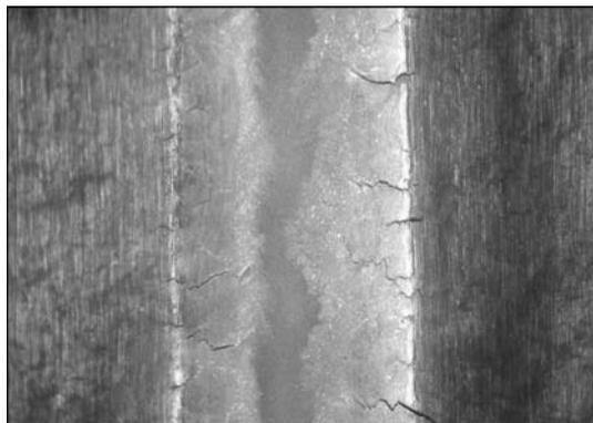
Рис. 7. Кристаллизационные трещины в швах, выполненных проволокой Inconel@52MSS (×10)
