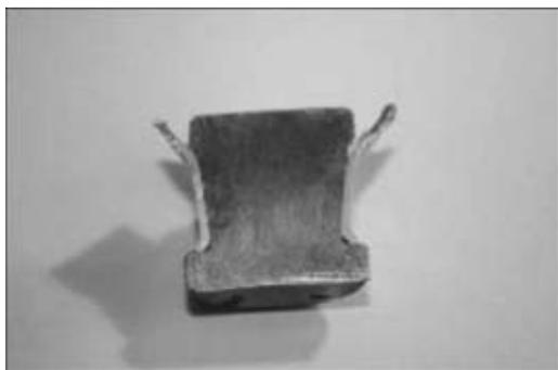
Рис. 7. Фрагмент поперечного сечения медноалюминиевого соединения (диаметр 25 мм)
