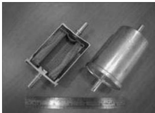
Рис. 9. Топливный фильтр, изготовленный с помощью МИС
