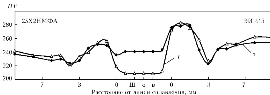
Рис. 6. Распределение твердости металла поперек комбинированного сварного соединения сталей 25X2NMFA + ЭИ 415: 1, 2 — сварное соединение со швом, выполненным соответственно проволоками Св-08ХН2ГМЮ и S 3 NiMoCr
