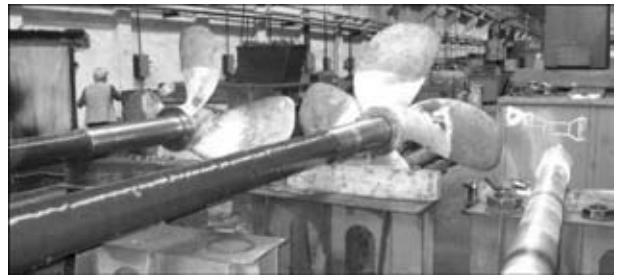
Рис. 5. Гребной вал в сборе с винтом
