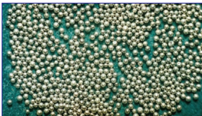
Общий вид сферических гранул плавящихся карбидов вольфрама
