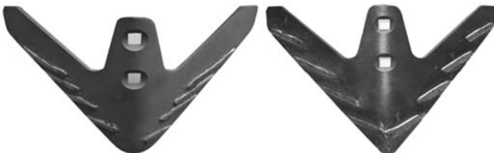
Рис. 5. Общий вид лапы после локального упрочнения [10]
