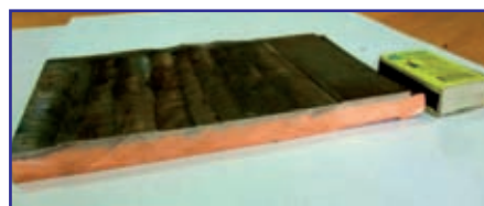
Фрагмент 10-миллиметровой медной плиты, наплавленной никелем толщиной 3,5 мм
