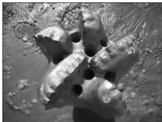
Рис. 3. Местоположение вида износа на буровом долоте
