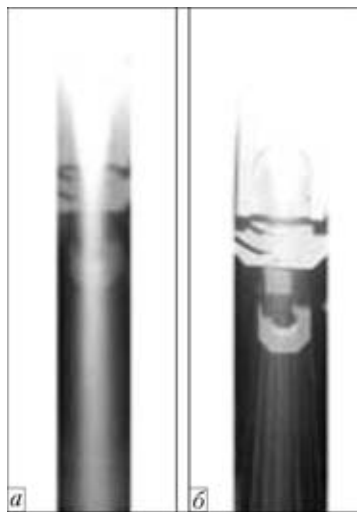
Рис. 3. Вид плазменной струи при напылении металлического (а) и керамического (б) порошков
