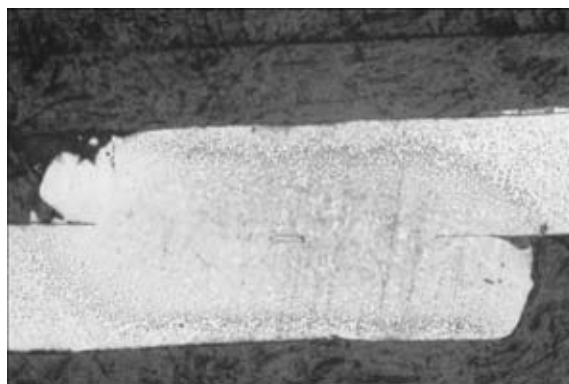
Рис. 6. Макрошлиф (×50) сварнопаяного соединения по сечению вблизи центра соединения
