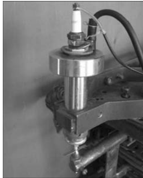
Рис. 3. Сварочная головка с механизмом ударной обработки сварного шва взрывного типа
