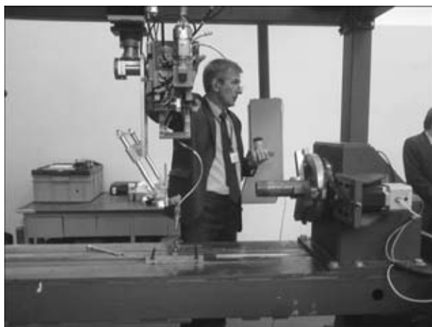
Демонстрация возможностей трехкоординатного портального манипулятора, снабженного оптической головкой с системой сканирования излучения фирмы «Trumpf»
