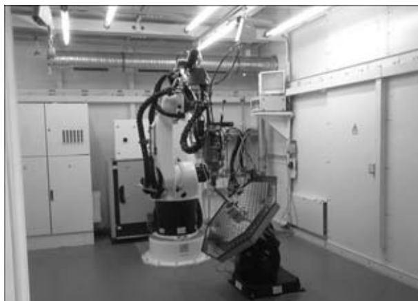
Вид внутреннего пространства защитной камеры лазерного технологического комплекса TruLaser Robot 5020, снабженного антропоморфным роботом-манипулятором фирмы «KUKA»
