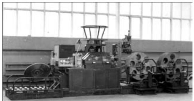
Рис. 4. Стан ОБ 2240 для изготовления двухзамковой порошковой ленты
